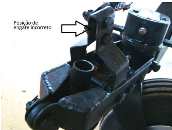
Essa foto foi realizada em um rebocador não presente no campeonato e verifica-se também a ausência do calço de borracha (53) que deveria estar encaixado no tubo.
