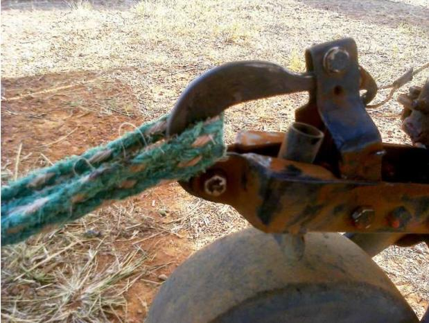
Seguem outras fotos dos desligadores dos rebocadores do campeonato todos sem o calço de borracha (53). O cavalete com apenas um parafuso trata-se de uma peça mais recente ou modificada pelo operador. Na ultima foto o desligador já não conta mais nem com o tubo onde se encaixa o calço de borracha (53).
